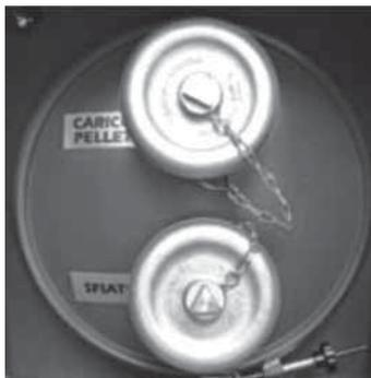
Handbefüllung: die Inspektionsluke öffnen und den Inhalt der Pellet-Säcke oder Big-bags einfüllen. Die Luke kann nur verschlossen werden, wenn sie exakt positioniert ist, d.h. der Deckel "Carico Pellet" (Pellet Laden) muss zur Mitte des Tanks hin ausgerichtet sein, wo sich im unteren Teil die Schlauch-Kurve befindet. Sollte der Deckel nicht korrekt montiert werden, kann die Schnappverschlussklemme nicht geschlossen werden.
