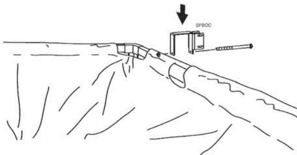
Fixer la bouche de remplissage (BOCA) avec l'attache storz inclinée d'environ 10/15° vers le bas. S'il n'y a pas d'espace au-dessus du magasin, tourner de 180° le support de fixation, (SPBOC) et installer la bouche de remplissage en utilisant le manchon inférieur. Dans ce cas, la capacité du magasin sera légèrement réduite (voir spécifications du modèle).
