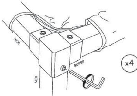
Insérer les raccords intermédiaires (HOR) dans les raccords intermédiaires (INTSP) et serrer les vis. Vérifier que tous les œillets de tenue sont également étirés, tendus vers le haut.
