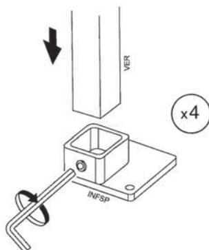
Insérer les raccords intermédiaires (INTSP) dans les tuyaux verticaux (VER), les fixant à la hauteur spécifiée dans le schéma, et serrer les vis.
