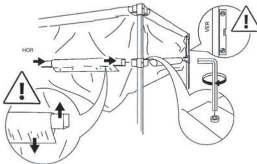
Positionner le support de fixation (SPBOC) au centre du tuyau supérieur, en adéquation avec l'œillet sur la toile et fixer le avec la vis relative.
