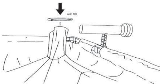
Insérer la bouche de remplissage jusqu'à ce qu'elle dépasse la couture du manchon en toile, puis serrer la bande. Il est recommandé de procéder à une mise à la terre de la bouche de remplissage.
