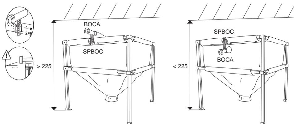
Insérer la petite bande (ABR100) dans le manchon supérieur de remplissage du magasin.
