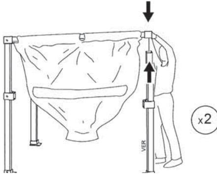
Fixer les raccords supérieurs (SUPSP) aux tuyaux verticaux (VER) et serrer le vis.
