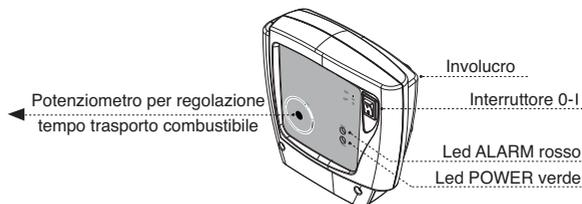
Il pannello di controllo presenta un led rosso "ALARM": quando questo rimane acceso, l'impianto di trasporto del combustibile si ferma; in questo caso il blocco può essere dovuto a diverse cause, alcune delle quali sono:
