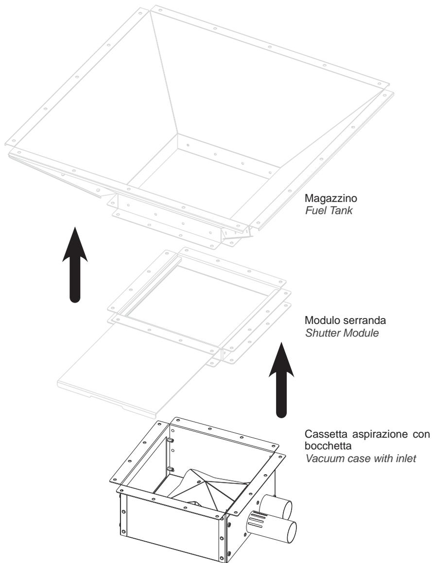
Evitare che la bocchetta di aspirazione aspiri oggetti che possano ostruire o danneggiare l'impianto. È consigliabile inserire tra il magazzino del pellet e la cassetta di aspirazione con bocchetta un modulo serranda (vedi catalogo).
