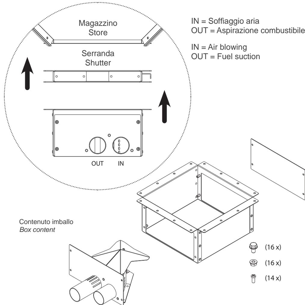
Collegare la bocchetta all'impianto con due tubi flessibili antistatici per un tratto di almeno 1 m ognuno. Notare che la griglia posta sul tubo di aspirazione del combustibile (fluidificatore) permette la regolazione della quantità di combustibile aspirato e trasportato.
