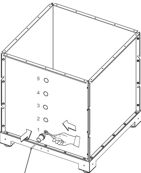
**OPTIONAL****Sensore di livello minimo***Minimum level sensor*
