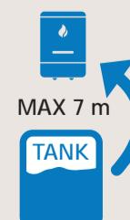
**IT** Massimo 7 m di dislivello tra il serbatoio e la caldaia.
