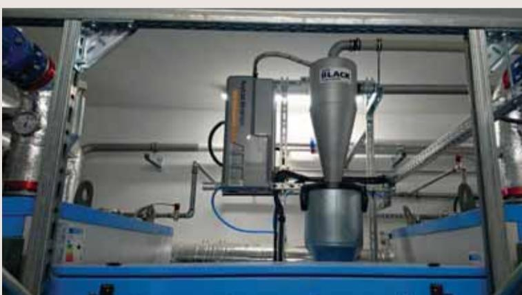
**IT** Il sistema di autopulizia del filtro permette di prolungare l'efficienza dell'impianto aspirante, riducendo la manutenzione al filtro. È programmabile a seconda delle esigenze di funzionamento.
