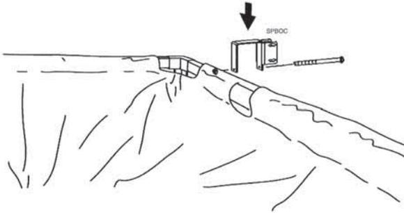
Fissare la bocca di riempimento (BOCA) con l'attacco storz inclinato di circa 10/15° verso il basso. Se non c'è spazio sopra il silo, ruotare di 180° la staffa di fissaggio, (SPBOC) ed installare la bocca di riempimento utilizzando il manicotto inferiore. In questo caso la capacità del silo verrà leggermente ridotta (vedi specifiche del modello).
