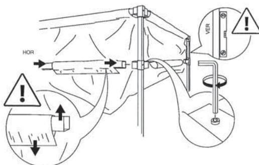
Posizionare la staffa di fissaggio (SPBOC) al centro del tubo superiore, in corrispondenza dell'asola sul telo e fissarla con la relativa vite.
